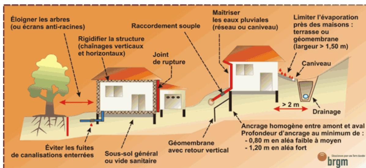
Figure 43 Les principes à mettre en œuvre pour construire sur terrain argileux. BRGM, 2010
