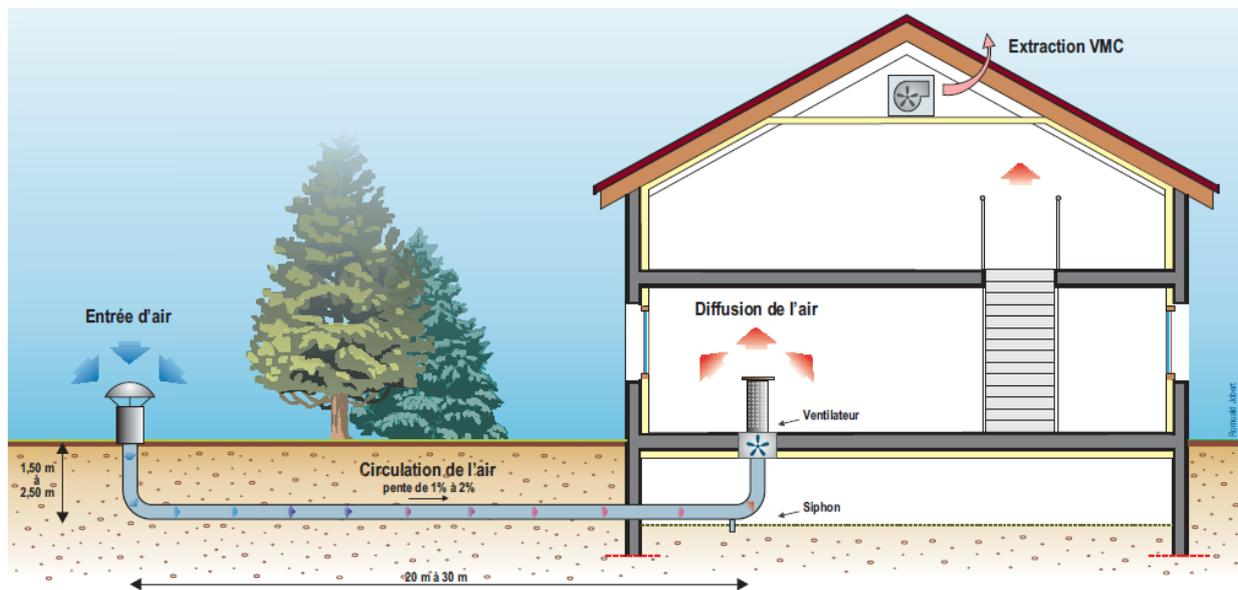
Figure 50 Schéma de principe d'un puits canadien. CETE de Lyon, 2005
